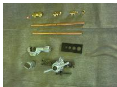
フレアツールと寸法ゲージ
