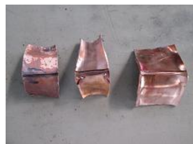
ろう付部を切断し内側評価
